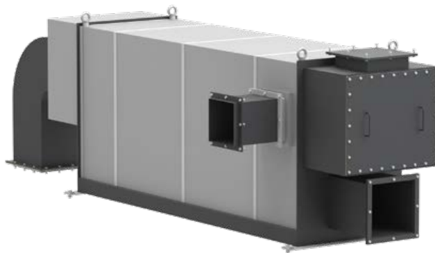
■ Подогреватель воздуха, подаваемого на горелку с гладкими трубами для увеличения КПД на 4-5%.
